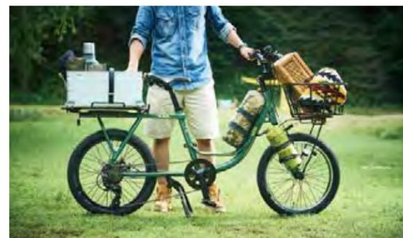
ログワゴンは、アウトドアライフに特化した多機能自転車で、特に後部荷台を丈夫かつ幅広に拡大可能に作りとすることで荷物の積載量を大きくしています。また、前後の荷台に加えて、フレームにさまざまなオプションを追加できるようにしています。小径車ながら、走行性や制動性を高める工夫をちりばめ、幅広のタイヤは非舗装道路での安定した走行を可能にしています。
